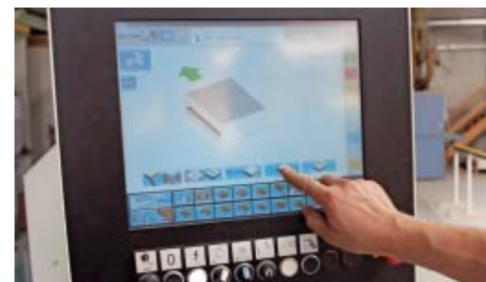
/ Mit der NC-gesteuerten Kantenbearbeitung spielt die Losgröße keine Rolle mehr: Nur wenige Buttons auf dem Touchscreen der „One Touch“ von Stefani antippen – und schon geht es voll automatisiert weiter.
