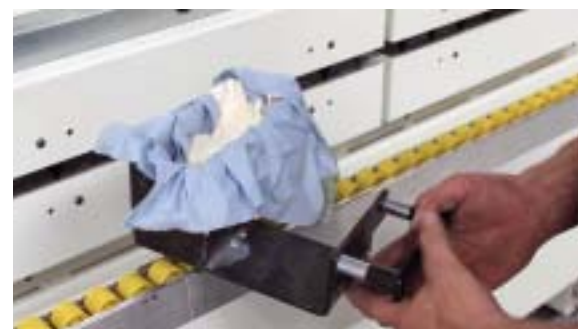
/ Klebstoffwechsel: Gespült wird in der Maschine, der Behälter für den Klebstoffrest wird einfach an der Vorderseite entnommen.
