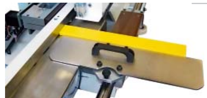
/ Sinnvolles Zubehör: Der Einschieber ermöglicht die einfache und sichere stirnseitige Bearbeitung schmaler Werkstücke.
