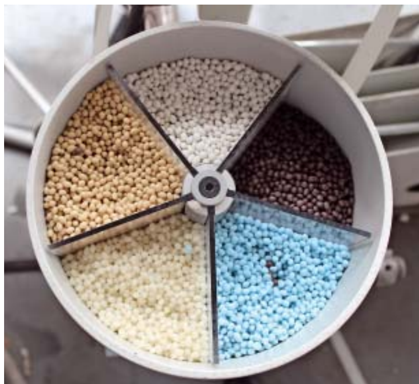
/ Pfiffige Lösung: Im segmentierten Leimbecken stehen bis zu fünf verschiedene Klebersorten zum schnellen Abruf bereit.
