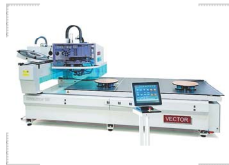
/ Wechselbetrieb: Während der Bearbeitung lässt sich die freie Maschinenseite mit einem neuen Teil bestücken.
