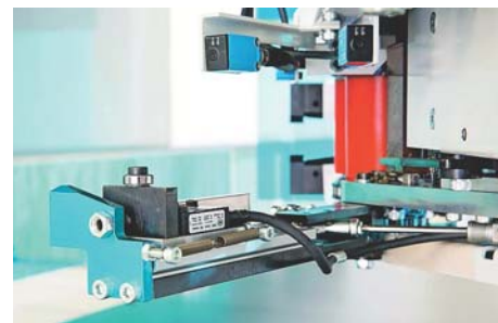
/ Für einen exakten und sehr sauberen Kantenstoß sorgt der Fühlerarm.
