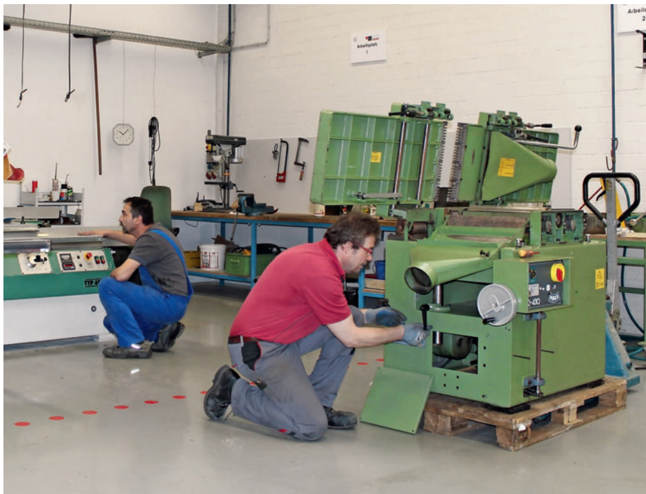
In der gut ausgestatteten mechanischen Werkstätte von Grupp werden Gebrauchsmaschinen von qualifizierten Maschinenfachleuten generalüberholt.
