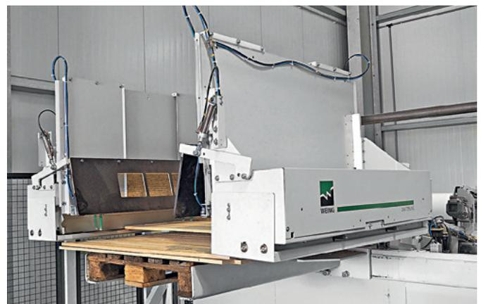
Der OptiCut Stacker ST10-2500 ist mit einer automatischen Lattenlegung ausgestattet und stapelt Werkstücklängen von 600 mm bis 2,5 m
