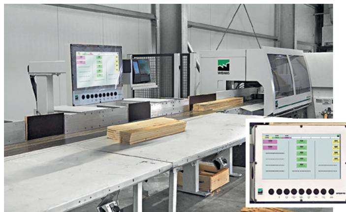
Auslaufseitig gibt es eine Sortierstation mit vier Paketabschiebern und einen Auslaufmonitor zur Anzeige der geschnittenen Längen
