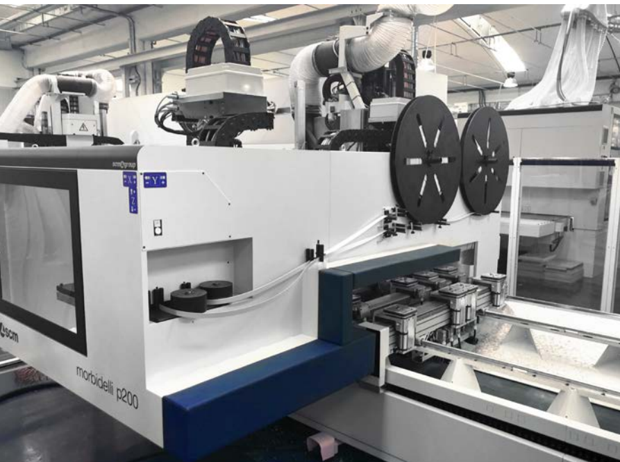
An dem Ausleger sind auf einer Seite sowohl die 5-Achs, Hauptspindel, das Bohraggregat wie auch das Kantenanleimaggregat untergebracht
