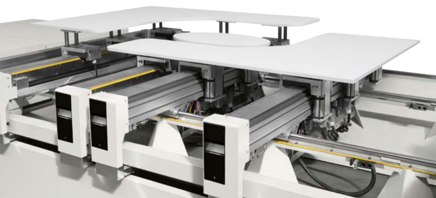
Der HE-POD-Sauger ermöglicht eine komplette Verschachtelung der Teile, inklusive Bekanten und stirnseitiger Bearbeitung
