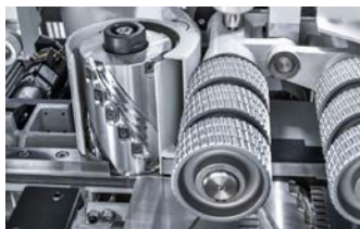
Die Spiralhobelköpfe sind mit Hartmetallschneiden bestückt, die viermal nutzbar sind und eine hohe Verschleißfestigkeit aufweisen
