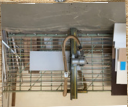
STEHENDE PLATTENSÄGE Striebig Econom 5206 E Baujahr: 1989 Art.-Nr.: SP-P-22017
