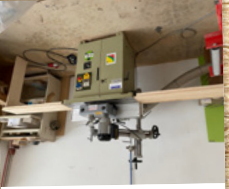
SCHWENKSPINDELFRÄSE G14 Baujahr: 1992 Art.-Nr.: TF-P-22001
