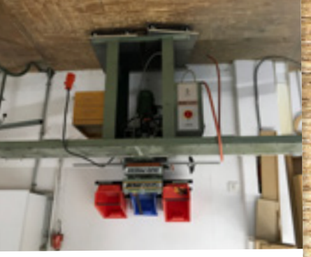
BESCHLAGBOHRMASCHINE Gannomat Duo Press Baujahr: unbekannt Art.-Nr.: BD-P-21018
