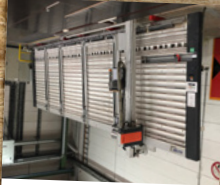
STEHENDE PLATENSÄGE Elcon 280 DSXEA Baujahr: 2011 Art.-Nr.: SP-K-22001
