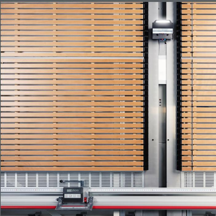
Zusätzliche Plattenabsenk-Einheit bis Mittelauflage
