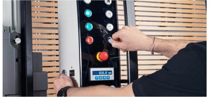
Ein serienmäßiges digitales Mess-System inkl. motorisierter Feineinstellung für die horizontalen Schnitte, ein digitales Mess-System inkl. manueller Feineinstellung unterstützen den Bediener. Zusätzlich ist eine lasergestützte Anzeige des horizontalen Schnittes im Standard enthalten.
