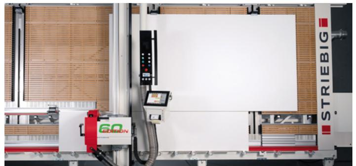
Die schnell und präzise verfahrenen Plattenabsenkeinheiten positionieren ohne Last mit 10 m/min und bewegen die Werkstücke unter Last mit 5 m/min. Dabei können pro Einheit bis zu 80 kg bewegt werden.
