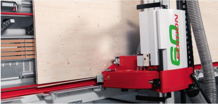
Nach dem Besäumschnitt können einfach die Streifen erzeugt und in einem Arbeitsfluss auf Länge zum Fertigteil zugeschnitten werden. Die Restplatte wird dabei zuverlässig gehalten.
