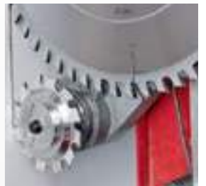
Vorritz-Sägeaggregat VSA (Ritzsäge stufenlos einstellbar).
