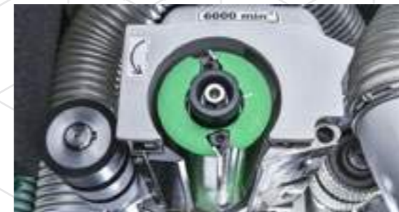
Hobelköpfe mit EasyLock System vereinfachen den Messerwechsel.
