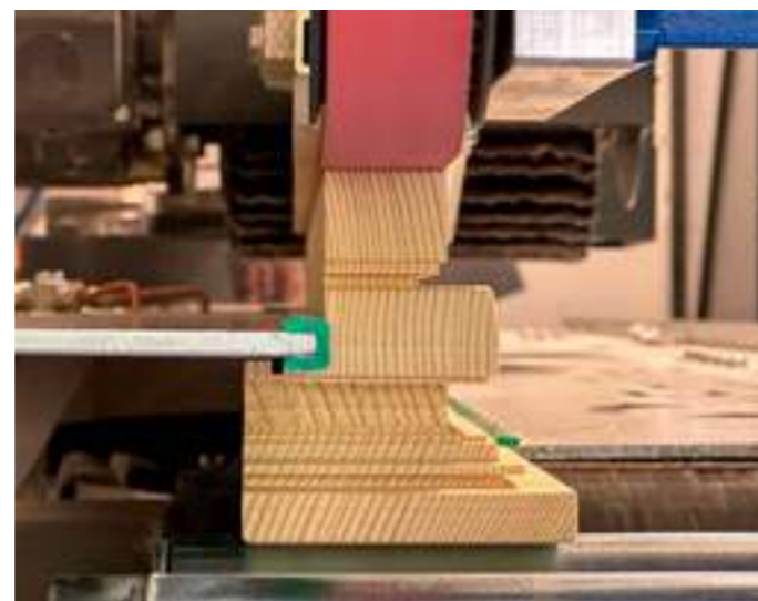
Beispiel, wie bei einem Holzalu-Flügelprofil der linke Anschlag in andere Positionen eingestellt werden kann.
