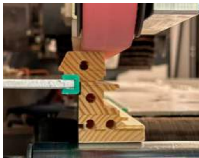
Beispiel, wie bei einem Flügelprofil der linke Anschlag in allen Ebenen eingestellt werden kann und das Teil perfekt führt.
